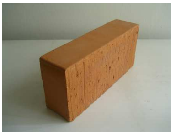
Figura 12.1 - Esempio di mattone pieno \phi \leq 15\% in laterizio per murature portanti 1
